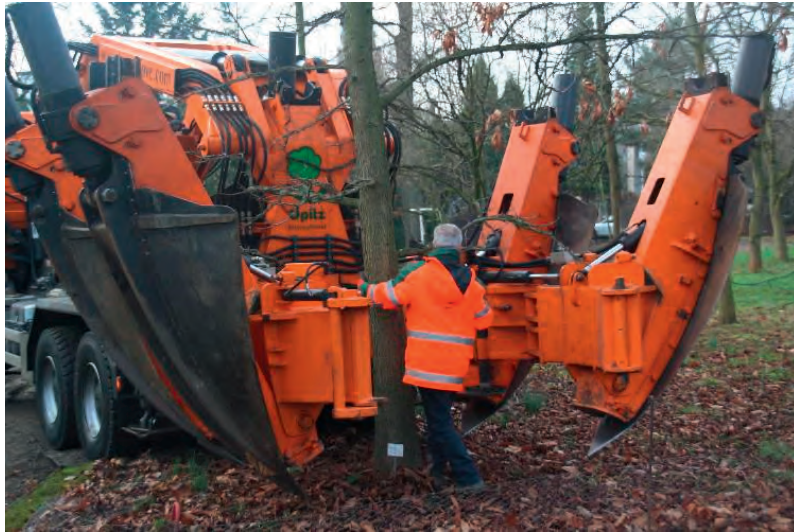
Die Spatenmaschine wird in Position gebracht
